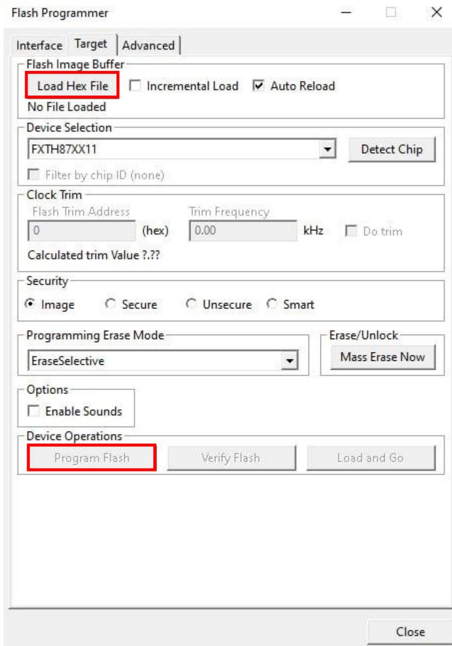
3. Для завершения операции установки программного обеспечения на колесный модуль необходимо нажать кнопку ProgramFlash в разделе DeviceOperations.
